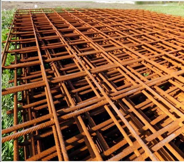
图 2-5 钢筋网片锈蚀
