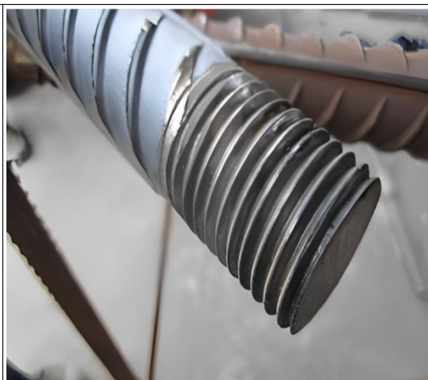
图 2-2 端口切割平整
