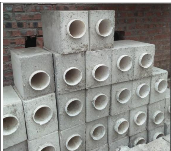
图 5-21 混凝土空调洞预制块
