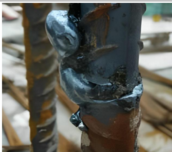
图 2-9 焊包不饱满、轴线偏移、未顺肋
