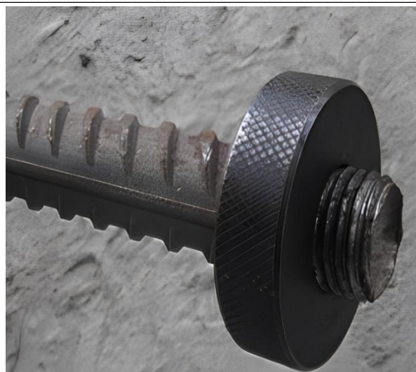
图 2-4 用通止规进行检查
