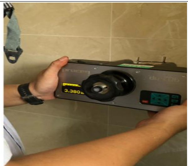
图 11-8 饰面砖粘结强度检测
