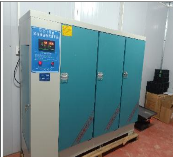
图 4-33 现场设置混凝土试块养护箱/室
