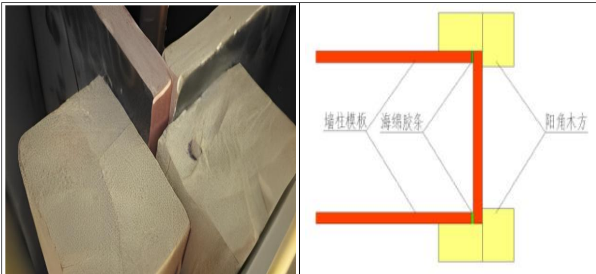
图 3-6 阳角方木加固处理
